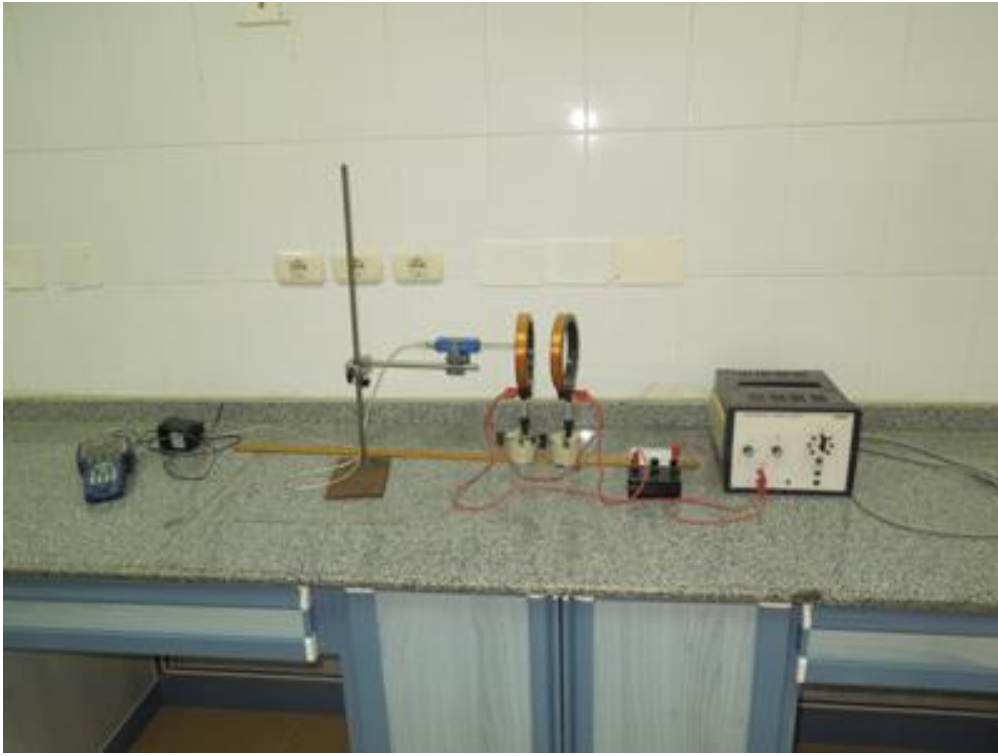
يستخدم هذا الجهاز لاستنتاج معامل النفاذية للهواء باستخدام ملف دائري.
