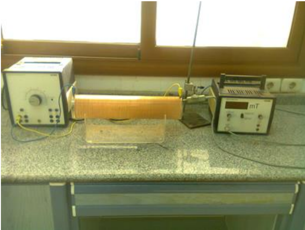
يستخدم هذا الجهاز لاستنتاج معامل النفاذية للهواء باستخدام ملف حلزوني.
