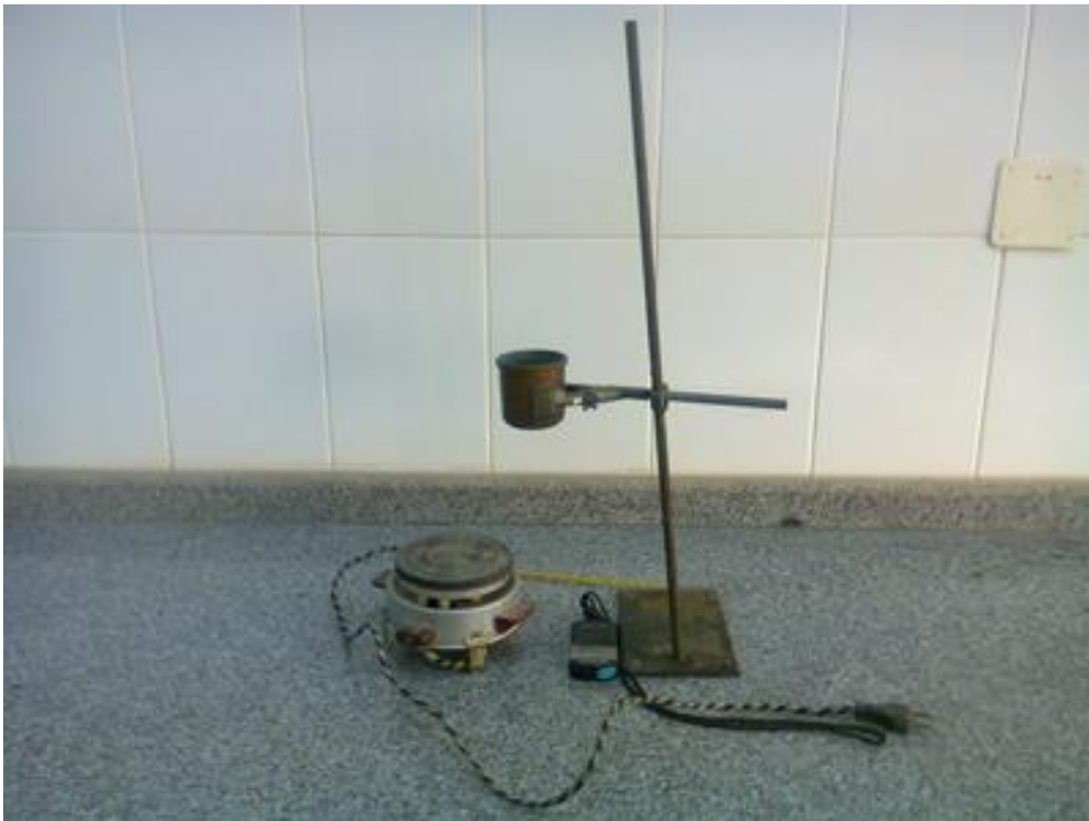
تستخدم هذه التجربة لتحقيق قانون نيوتن للتبريد
