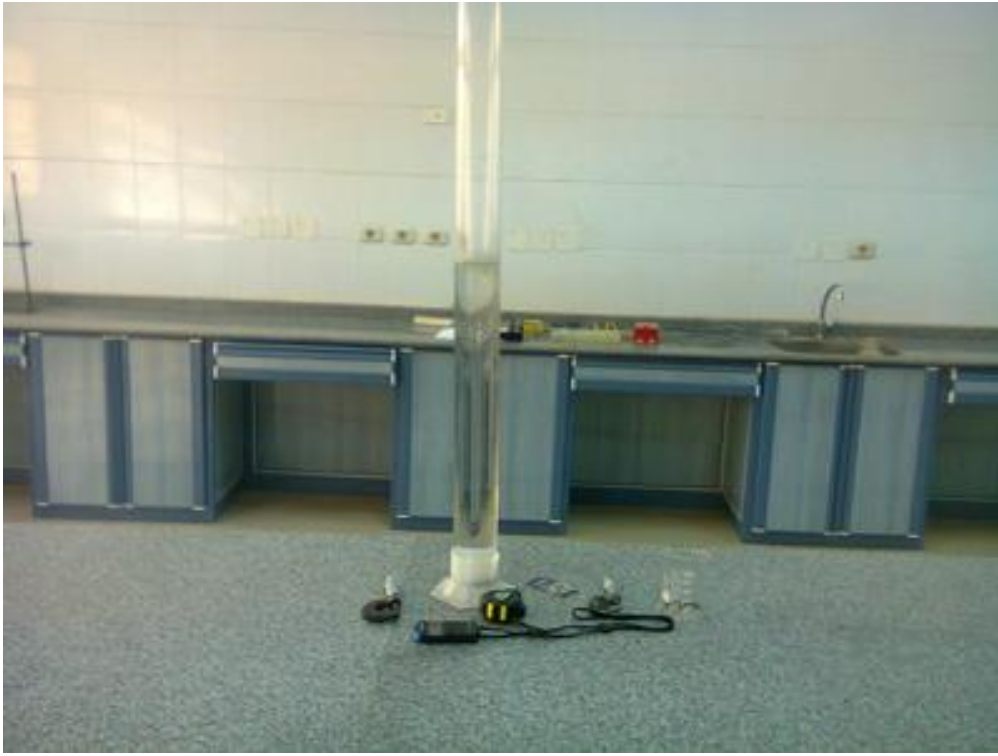
تستخدم هذه التجربة لتعيين معامل اللزوجة لسائل بطريقة ستوك
