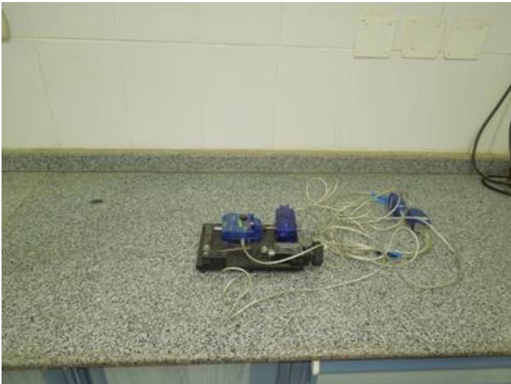
يستخدم هذا الجهاز لحساب معامل يانج
