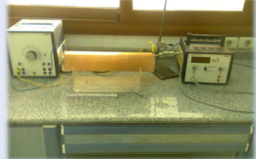
يستخدم هذا الجهاز لاستنتاج معامل النفاذية
