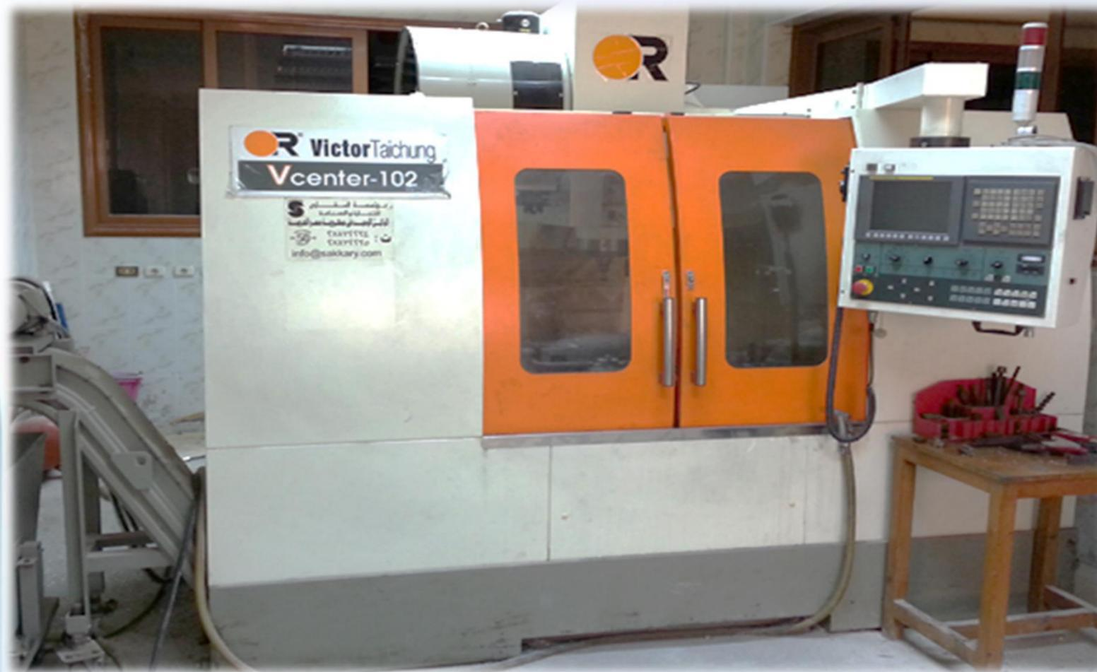
تُستخدم ماكينة التفريز باستخدام الحاسب الآلي (CNC) (شكل 3) في إنتاج الإسطمبات المختلفة التي تستخدم في خطوط الإنتاج بالمصانع والورش الإنتاجية المختلفة وذلك بدقة وسرعة عالية، وكذلك تنفيذ المشغولات ذات الأشكال المعقدة التي يصعب إنتاجها علي الماكينات التقليدية.
