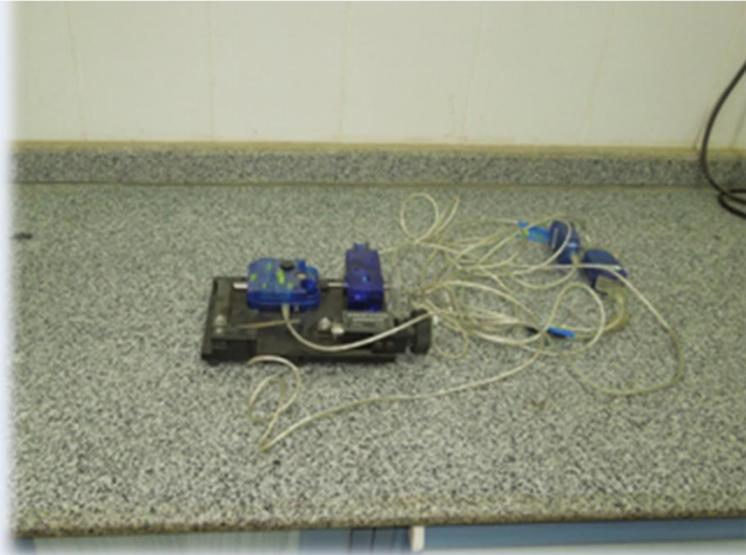
ويستخدم هذا الجهاز في قياس الحرارة النوعية لجسم صلب بطريقة الخلط
