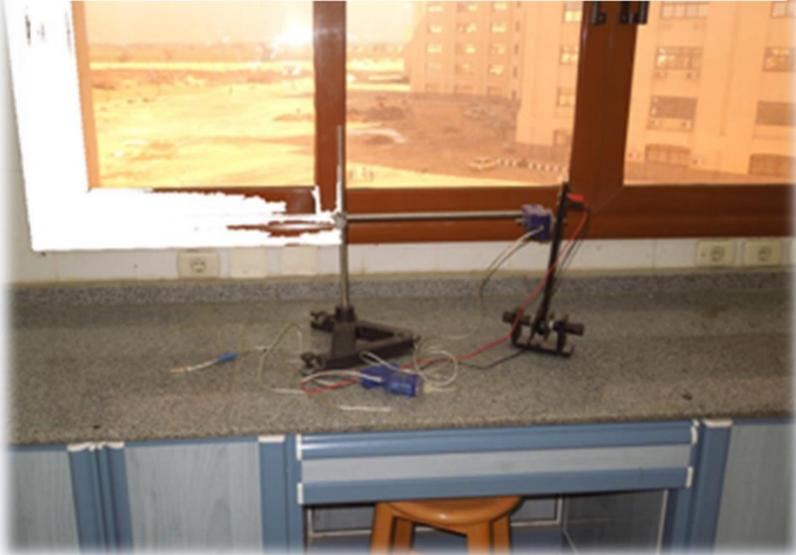
يستخدم هذا الجهاز لحساب معامل يانج
