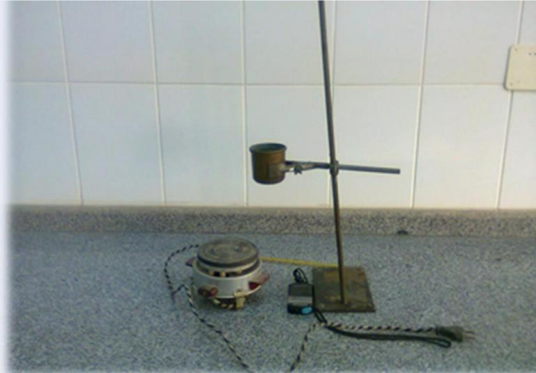
يستخدم هذا الجهاز لاستنتاج معامل النفاذية
